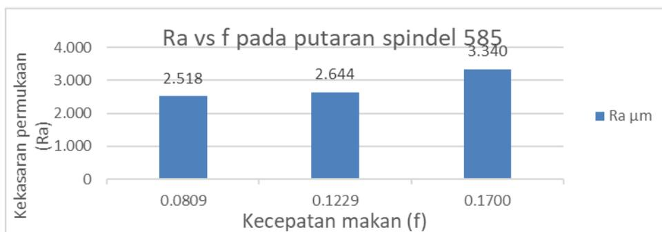
**Gambar 5 Ra pada Variasi f (feed) dan Rpm 585**
