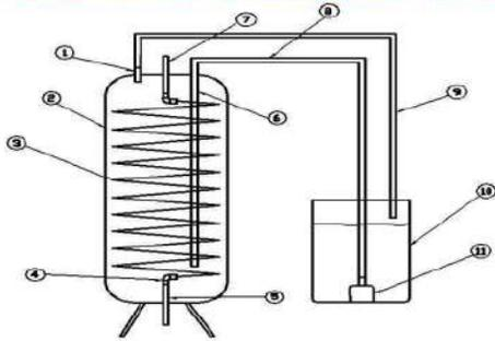
Gambar 4. Desain sistem sirkulasi air pendingin kondensor
