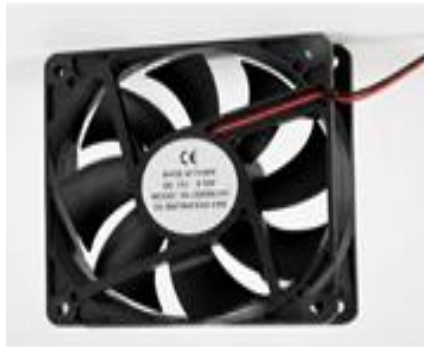
Gambar 5 Kipas DC 12V (Digunakan untuk menurunkan suhu)
