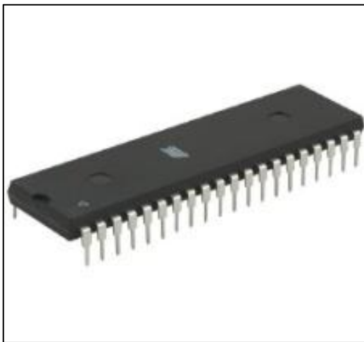
Gambar 2.1. Bentuk Fisik dari Mikrokontroler AT89S51
