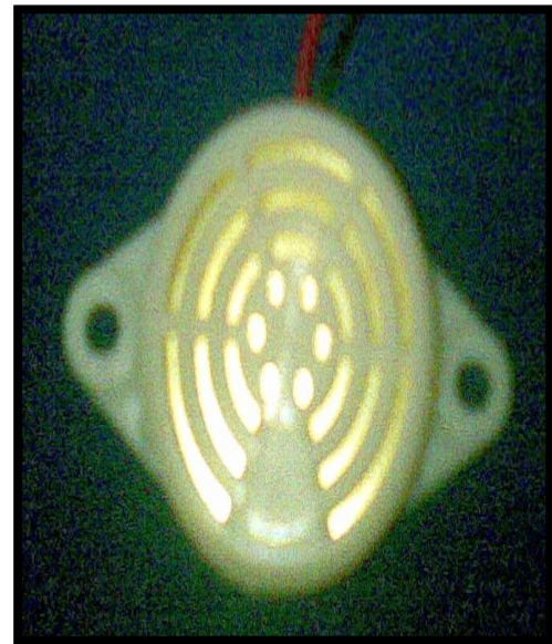
Gambar 4.4. Bentuk fisik dari alarm buzzer
