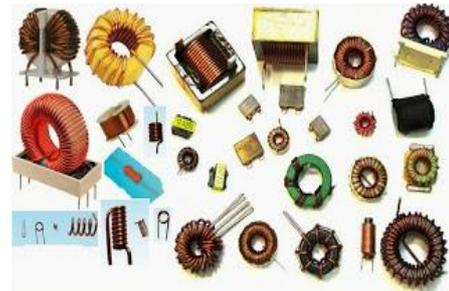
Gambar 6. Bentuk-bentuk Induktor
