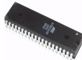
Gambar 2. Tampilan Fisik Mikrokontroller
