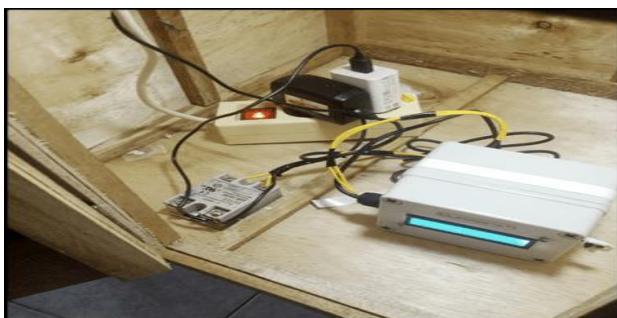
Gambar 2. Rangkaian Alat Kontrol Suhu
