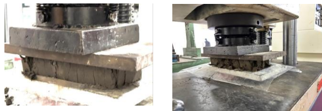
Gambar 4. Bentuk Retakan Pada Benda Uji
