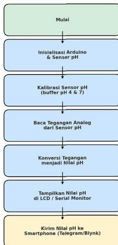
Gambar 3 Alur sistem pengukur ph kotoran
