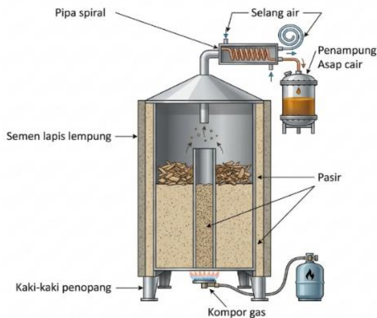
Gambar 1. Skema alat pirolisis lambat TKS berbahan bakar gas LPG
